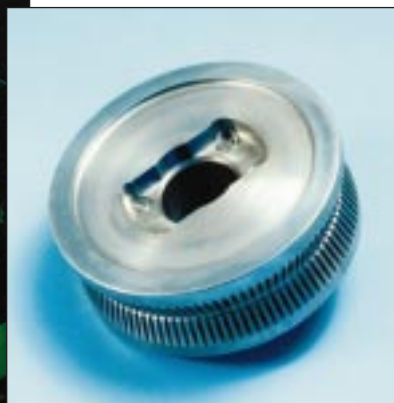
Inmatningshjulen till den här skalsvarven håller fast arbetsstycket medan maskinen roterar. Hjulen håller nu tre gånger längre tack vare att de tillverkas i HPS.
